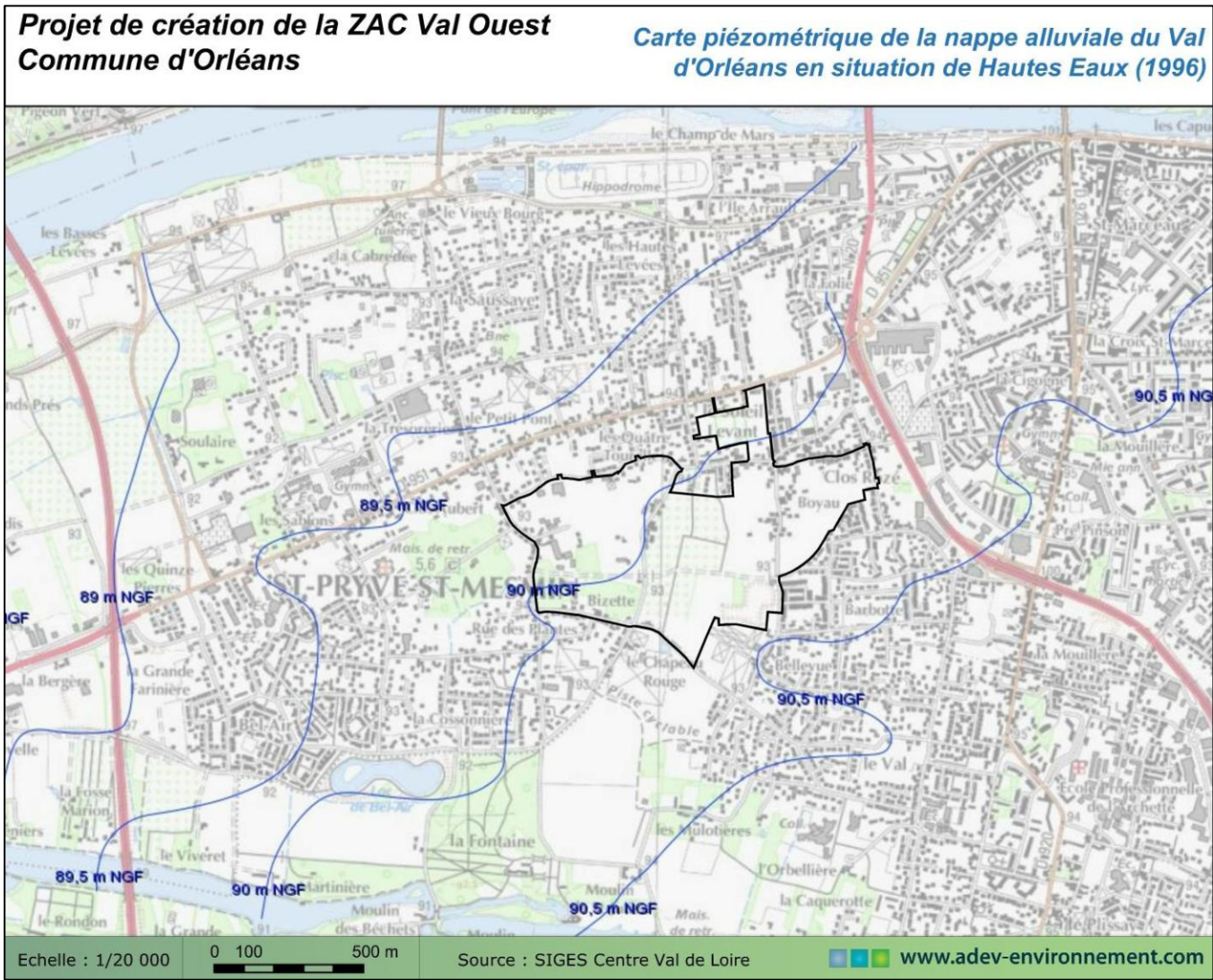
Figure 23 : Carte piézométrique de la nappe alluviale du Val d'Orléans en situation de Hautes Eaux (1996) Source : SIGES Centre Val de Loire
